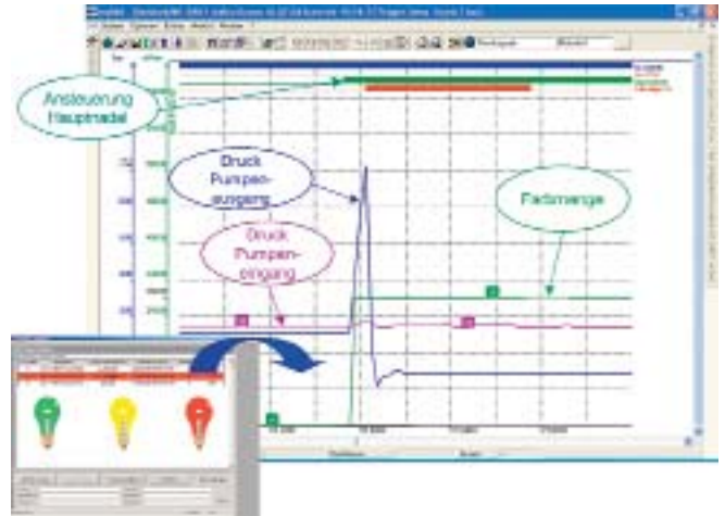
Beispiel: Hauptnadel wird vor Start Dosierpumpe angesteuert, öffnet aber zu spät. Dadurch steigt der Druck am Pumpenausgang stark an.
