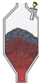
VEGA-Sensoren erlauben die Ermittlung von Füllständen für eine Reihe unterschiedlicher Umgebungen und Materialien, wie z.B. in Hochöfen
