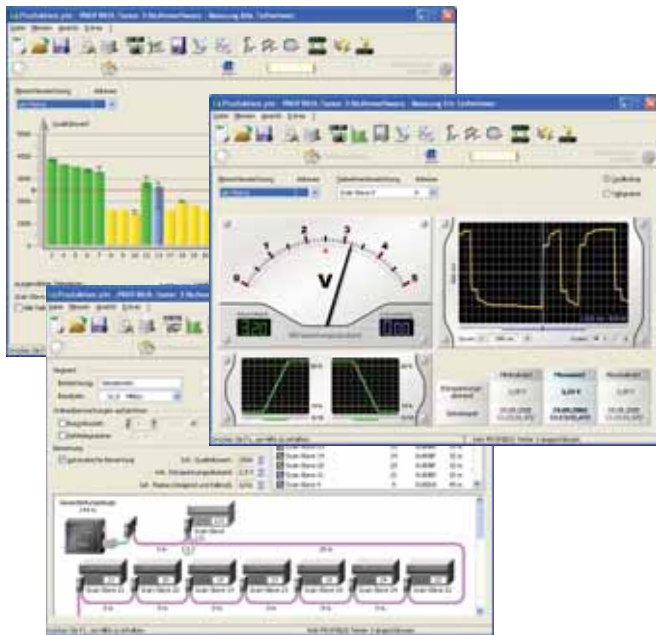
PB-T3 ermittelt Signalgüte und Topologie
