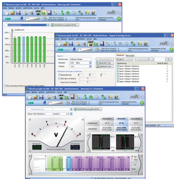
BC-200-CAN ermittelt die Signalgüte CAN-basierter Netzwerke
