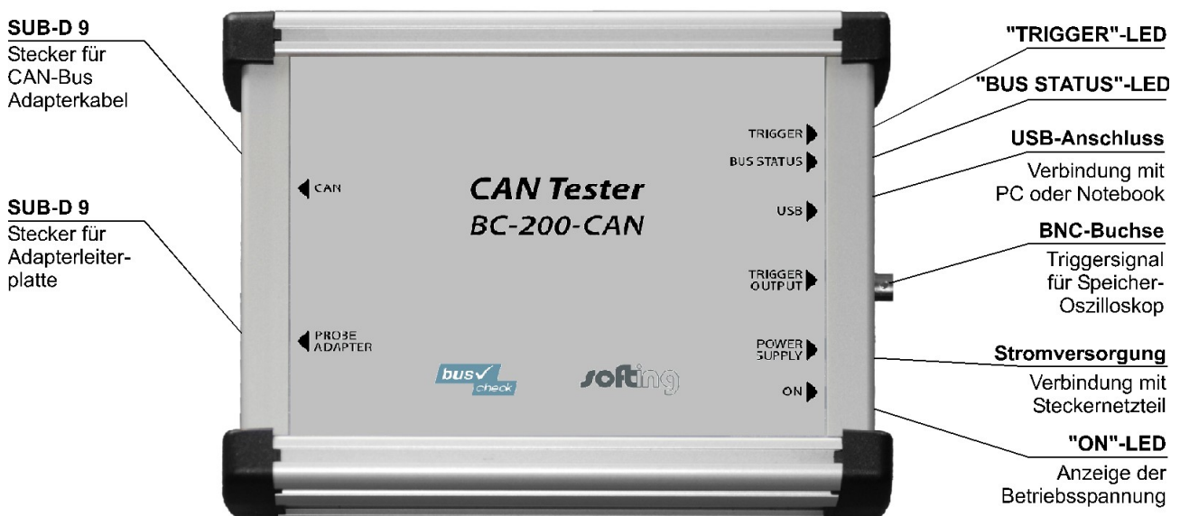
Abbildung 1: Anschlüsse des BC-200-CAN
