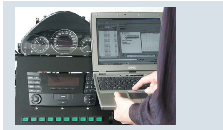
DTS-Flash im Einsatz am Bretttaufbau
