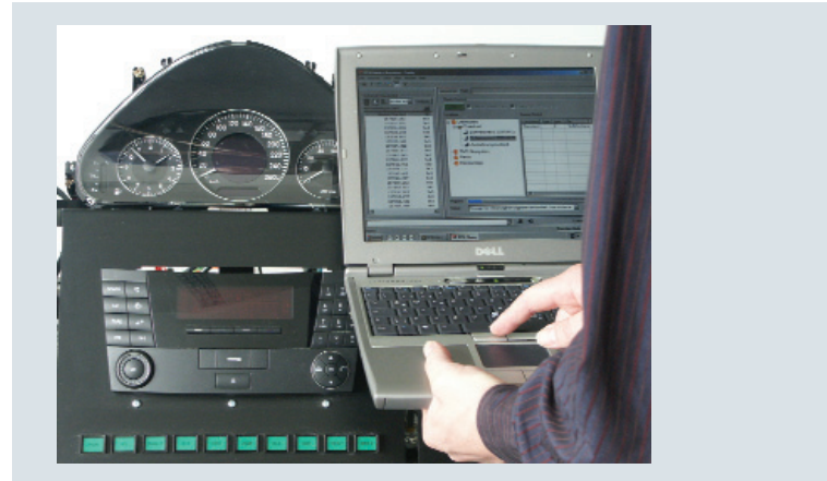
DTS-Flash im Einsatz am Bretttaufbau
